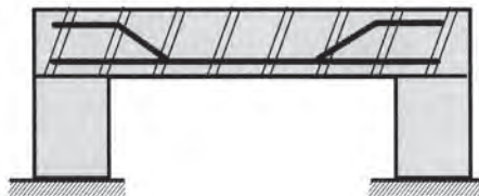
Σχήμα 10.45 Τοποθέτηση χάλυβα σε καμπτόμενη δοκό
