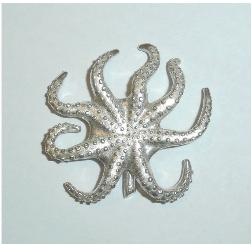
Εικόνα 36: Το εξάρτημα μετά τη χύτευση
