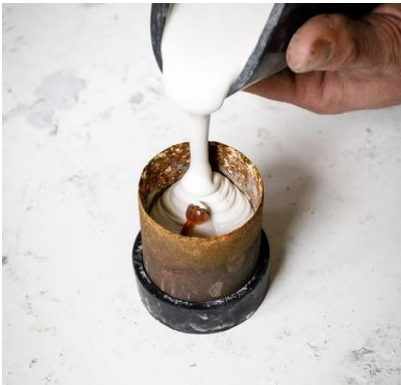
Εικόνα 17: γέμισμα 'ποτηριού' πηγή: Photography by Ryan Leggett , https://coreyegan.com/blogs/blog/how-its-made-lost-wax-casting-part-2-casting
