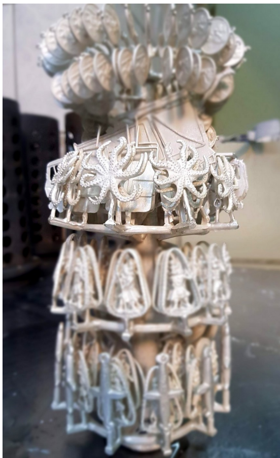
Εικόνα 49: το δέντρακι μετά τη χύτευση ασημιού 925
