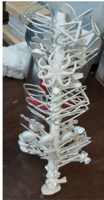
Εικόνα 41: το 'δεντράκι πριν' .....και μετά το χυτήριο
