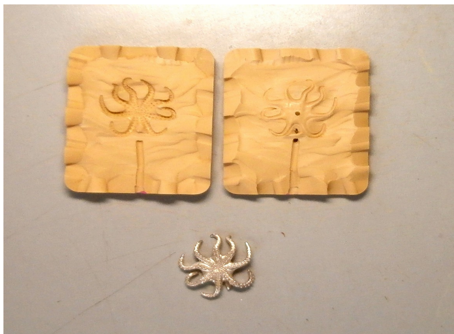
Εικόνα 44: το καλούπι ανοιχτό και το μοντέλο
