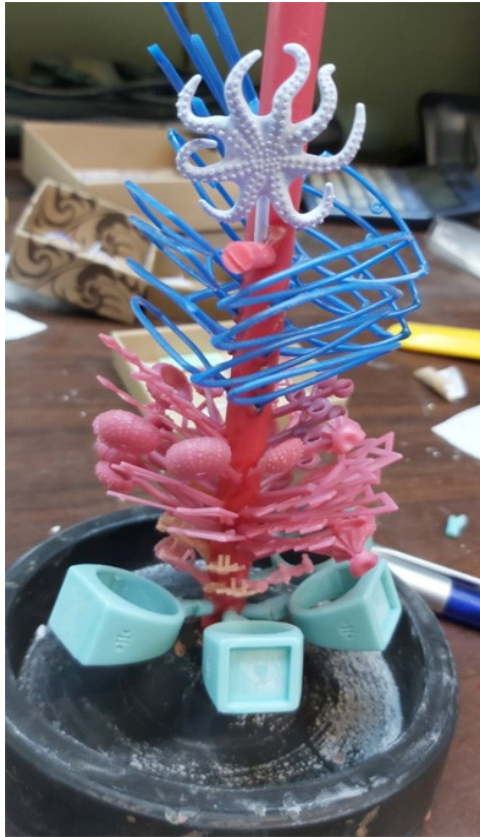
Εικόνα 41: το 'δεντράκι πριν' .....και μετά το χυτήριο
