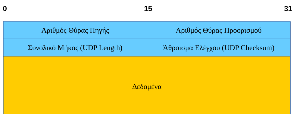
Σχήμα 4.5: Πεδία Επικεφαλίδας UDP Πακέτου
