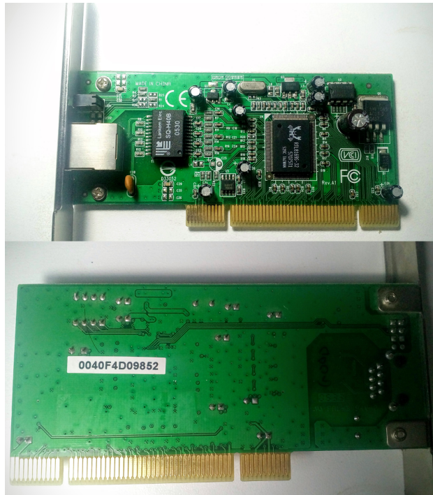
Σχήμα 2.4: Κάρτα Δικτύου Ethernet με αυτοκόλλητο που δείχνει MAC address
