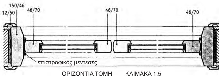
Εικ. 212 Μόνωση με κενό αέρος (διπλά τζάμια).
